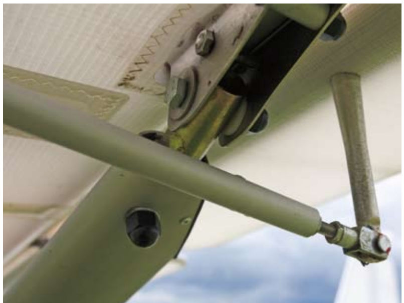
Gros plan sur la liaison du hauban profilé arrière et son attache sur le tube du bord de fuite. On notera aussi la commande rigide de l'aileron et la rotule réglable.
