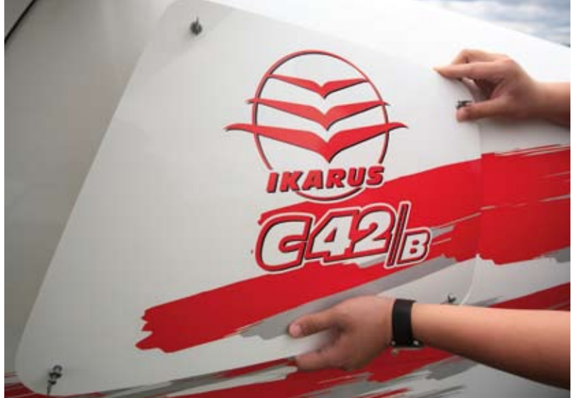
Pour accéder au coffre à bagage et à l'arrière de la machine pour la visite prévô, une vaste trappe d'accès s'ouvre par 4 verrous.
